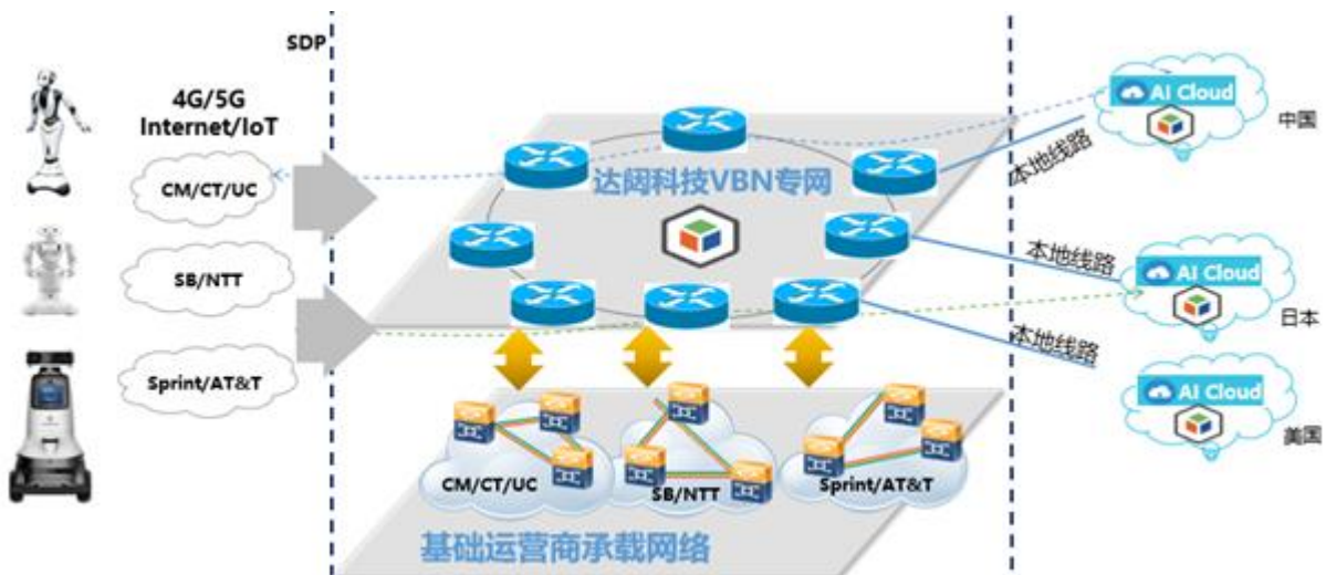
图 6：达闼科技 VBN 专网整体网络架构图
